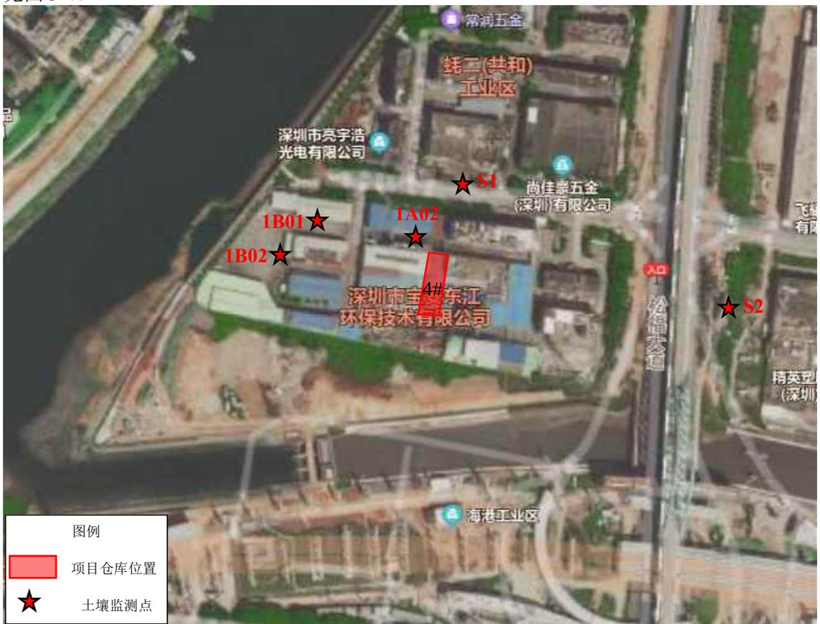
图 3-4 项目土壤监测布点示意图
